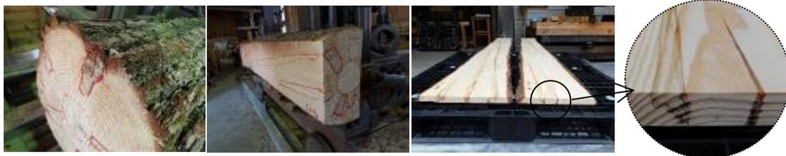
写真 2-36 材面の変色の様子
