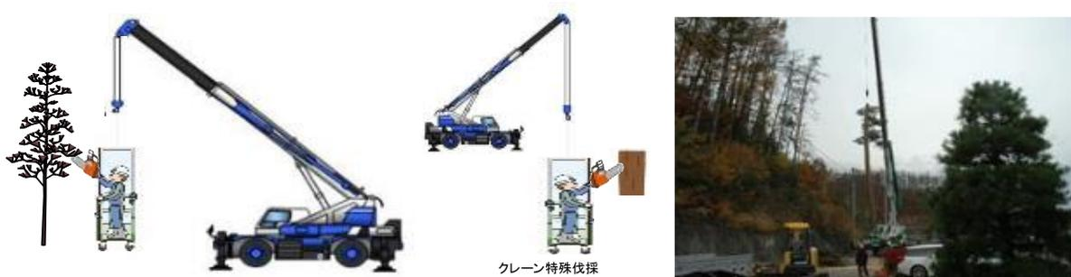
図 2-9 クレーン特殊伐採の模式図（左）と松本市における実施事例（右）
