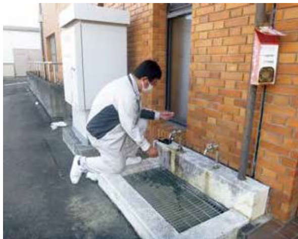
給水栓での色・濁り及び残留塩素検査
