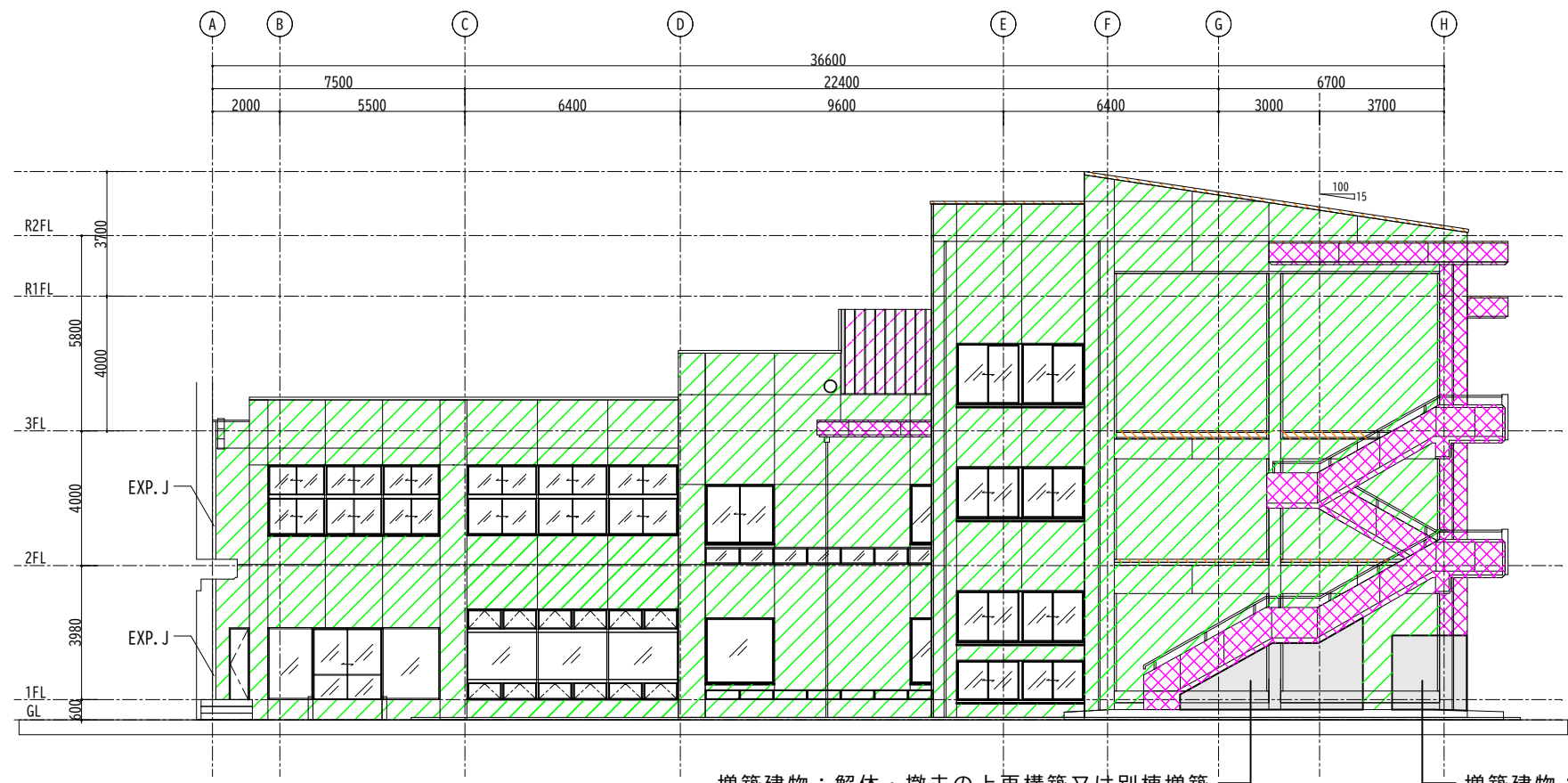
増築建物：解体・撤去の上再構築又は別棟増築 増築建物：移設 改修西立面図 A3:1/200 (A1:1/100)
