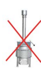
焼却炉の構造基準を満たさない簡易な焼却炉
